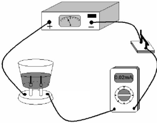
لدينا دائرة كهربائية متكونة من جهاز تغذية وأمبرمتر و محلول به ماء مقطر.
