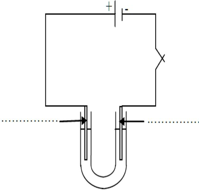
وضعنا في محلول كهربائي (على شكل حرف U) كل من المحلول المائي لكبريتات النحاس و المحلول المائي لبرمنغنات البوتاسيوم، كما هو مبين بالرّسم.
